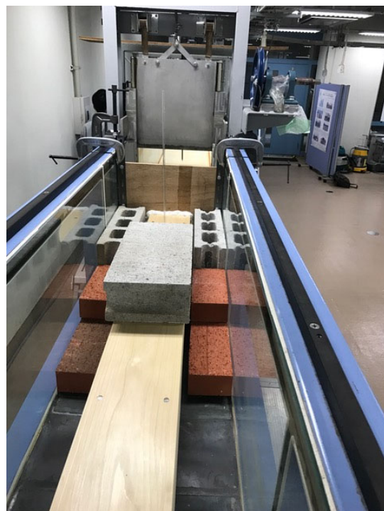
水理模型実験で木管の流量計測
